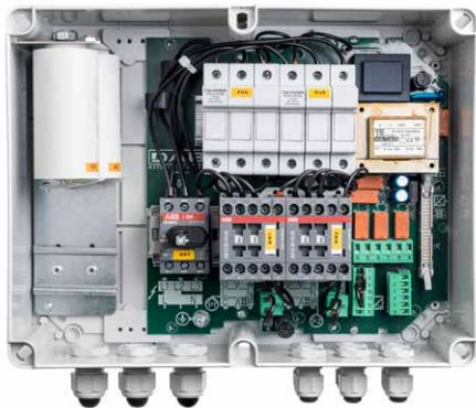
**e.box plus** è un quadro elettronico di comando per la protezione ed il funzionamento automatico di una o due elettropompe sommergibili o di pressurizzazione sia monofasi che trifasi, installate in ambito domestico, civile e industriale. Grazie alla possibilità di regolazione della corrente, il quadro **e.box** è compatibile con tutti i modelli di pompa con una corrente compresa fra 1 e 12 A con potenza fino a 5.5Kw come riportato dalla tabella compatibilità prodotti.
